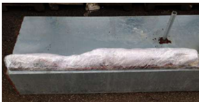
Figura 12. Elemento smontato della nave preparato per la polimerizzazione a caldo, rivestito con fogli di carta di cellulosa bagnata e avvolto in cellophan termoresistente
