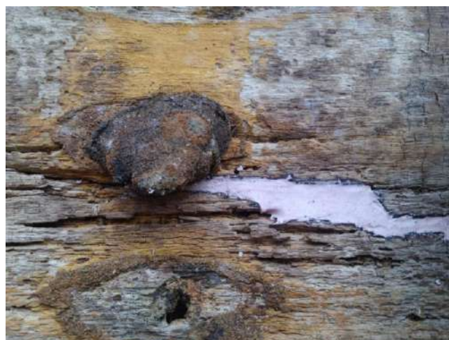
Figura 16. Integrazione effettuata con resina epossidica integrata con granuli di balsa. Da notare la traccia della cerchiatura esterna dell'imbarcazione ed i chiodi in ferro superstiti.
